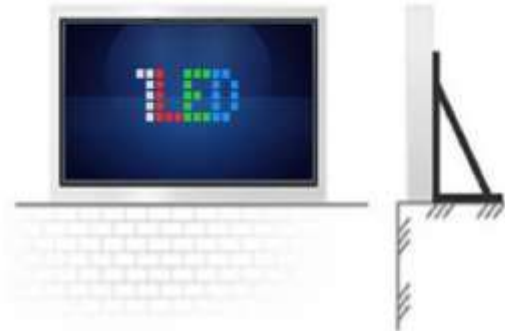
Размещение на крыше здания
